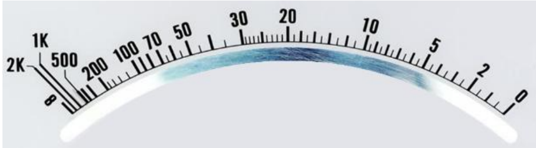
Hình 4.15: Thang đo không tuyến tính của Ohm kế từ điện
