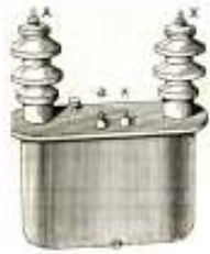
Hình 3.4: Máy biến áp đo lường VT
