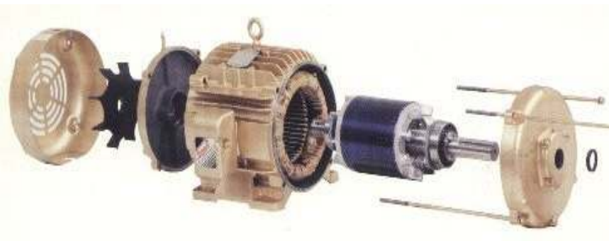
Hình 3.17: Cấu tạo của động cơ không đồng bộ ba pha
